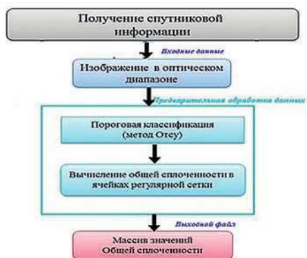
Рис. 5.3. Алгоритм работы программы по определению общей сплоченности.
