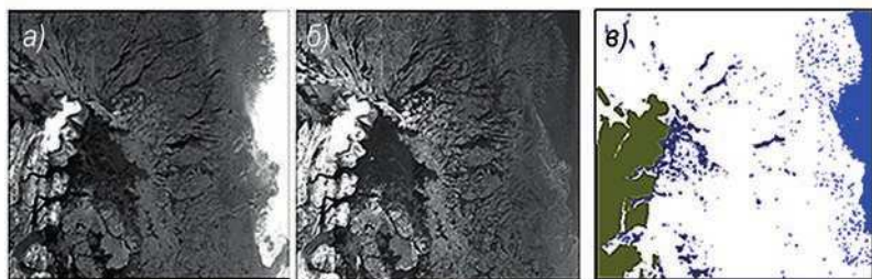
Рис. 4.11. Автоматическая классификация вода — морской лед по методу опорных векторов.
