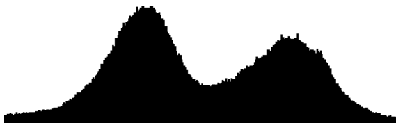
Рис. 5.1. Пример гистограммы спутникового изображения, использованного для бинаризации по методу Отсу.
